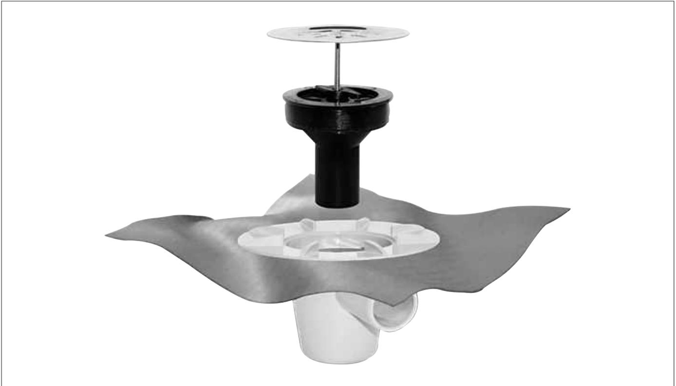
GULLY. Bote sifónico para platos de ducha de obra con tela de PVC impermeable. Sifón incorporado, fácilmente extraíble y rejilla diámetro 130 mm.
