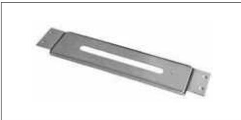
**AC-950** Base montaje para grupo sobre repisa. Soporte donde colocar las piezas sobre repisa y cubrir con azulejo. En caso de inspección, posibilidad de alzar para reparación o sustitución. Registro universal para cualquier serie.
