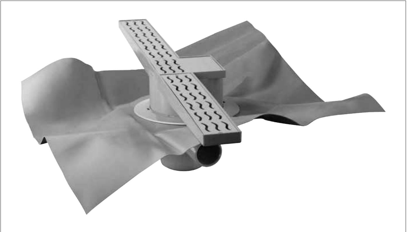
GULLY SKIPPER HORIZONTAL. Bote sifónico para platos de ducha de obra con tela de PVC impermeable. Sifón incorporado, fácilmente extraíble y rejilla lineal en INOX de 700 mm.
