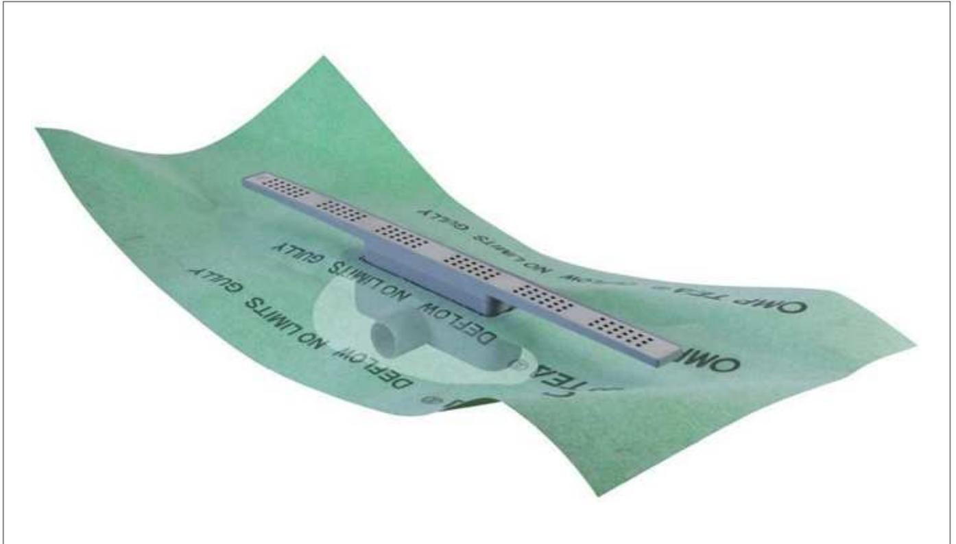
DEFLOW SKIPPER HORIZONTAL. Bote sifónico para platos de ducha de obra con Tejido Técnico impermeable. Sifón incorporado, fácilmente extraíble y rejilla lineal en INOX de 700 mm.
