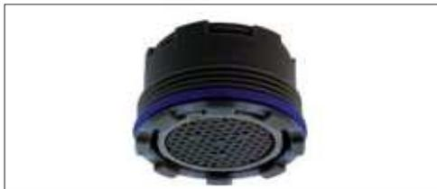
**AR8070Q** Aireador bañera tipo "CACHÉ" antirrobo 22x1M, para todas las series donde el aireador queda escondido dentro del propio caño.
