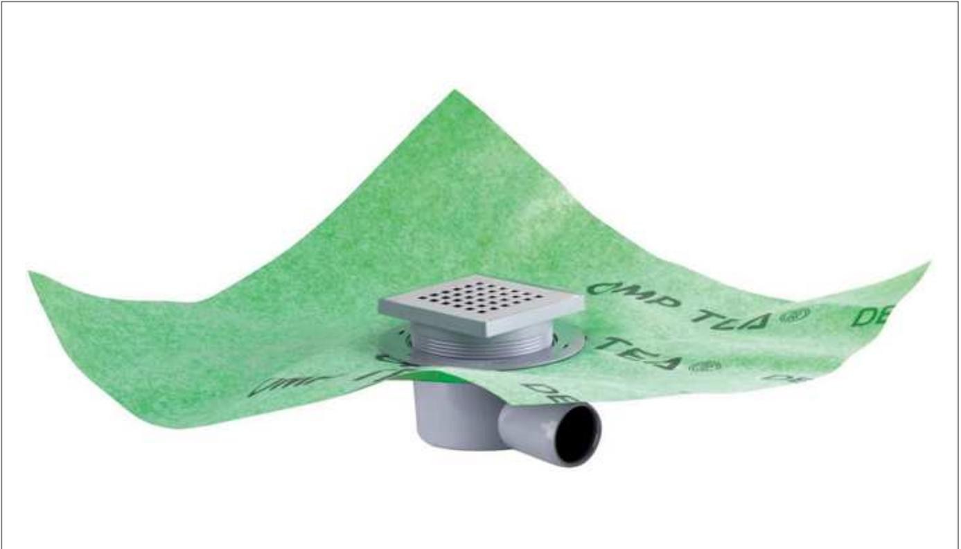
DEFLOW Q+Q. Desagüe plato de ducha de obra con Tejido Técnico impermeable. Sifón incorporado, fácilmente extraíble desde el exterior y rejilla cuadrada de 100x100 mm.
