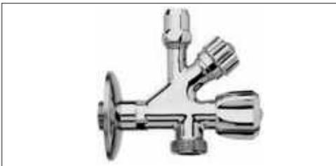
**E.O.R. 241C** Llave de regulación doble salida para lavadora 1/2" Mx3/8" Mx3/4" M.
