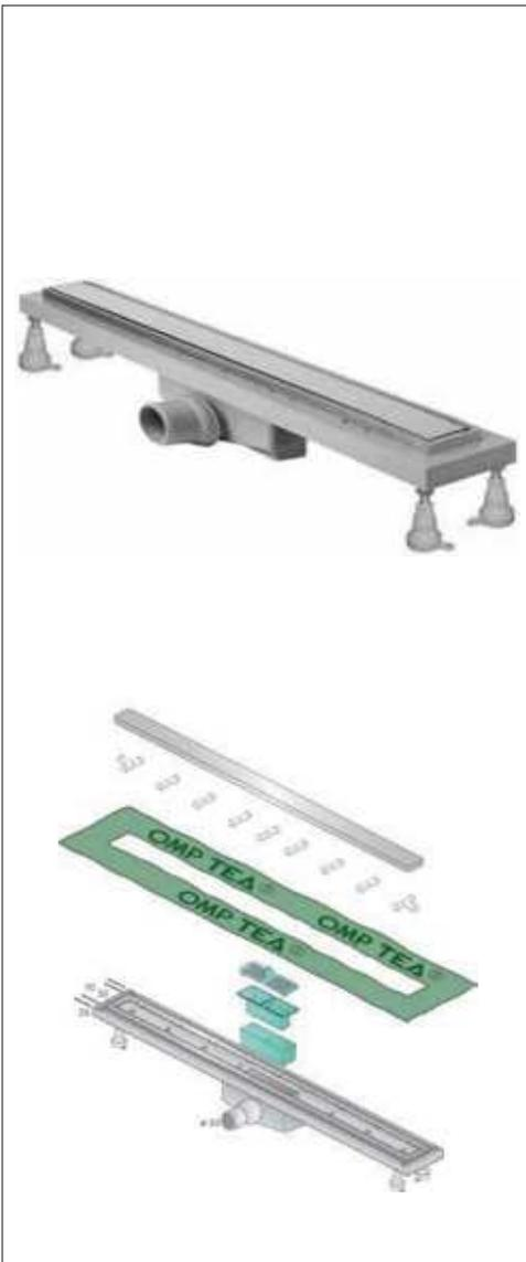
DEFLOW HORIZONTAL. Desagüe para plato de ducha de obra completo con sifón, rejilla y base de tela. Embellecedor reversible para colocar azulejo. Pedir los metros necesarios de tela (979.142.0) para sellar e impermeabilizar la ducha (pag. 436).
