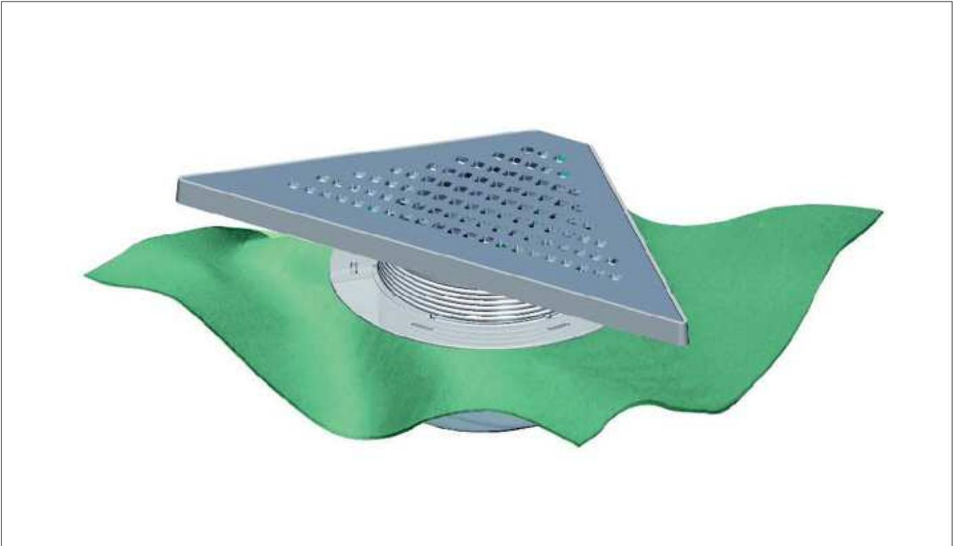
DEFLOW SKIPPER ANGULAR. Bote sifónico para platos de ducha de obra con Tejido Técnico impermeable. Sifón incorporado, fácilmente extraíble y rejilla angular en INOX de 400x400 mm.
