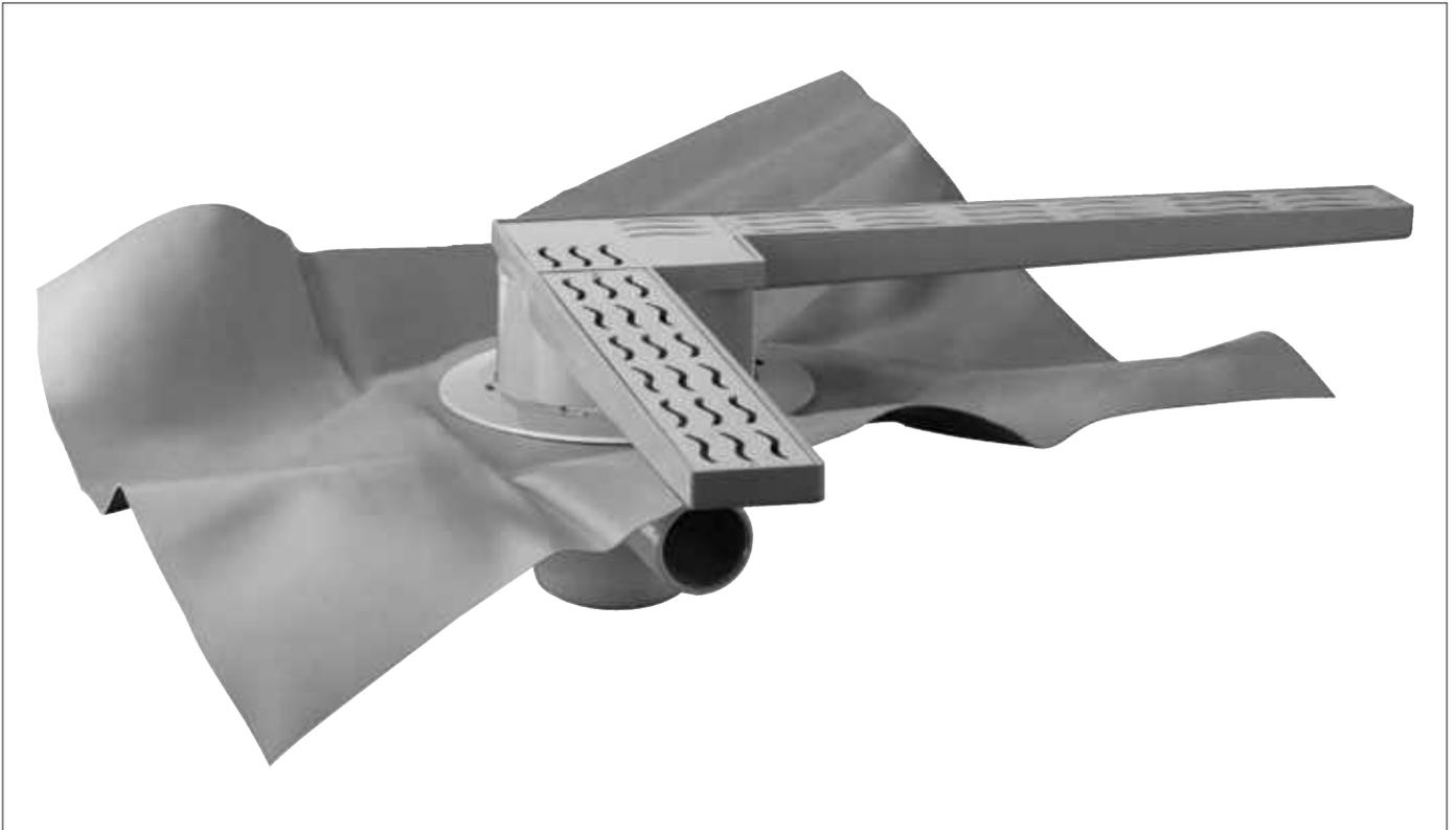
GULLY SKIPPER ANGULAR. Bote sifónico para platos de ducha de obra con tela de PVC impermeable. Sifón incorporado, fácilmente extraíble y rejilla angular en INOX de 400x400 mm.
